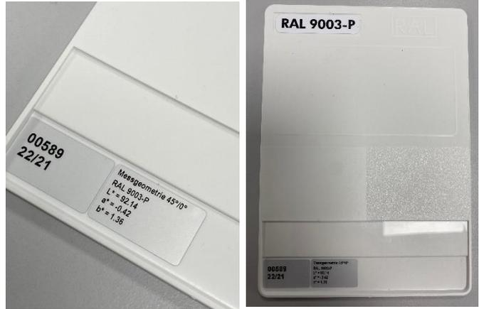
화이트 레퍼런스로 선택한 RAL 플라스틱 색상 카드를 광학 센서 프런트 엔드에서 약 75mm 떨어진 곳에 배치합니다. 이때 RAL 플라스틱 색상 카드의 뒷면이 위(광점 쪽)로 향하도록 주의합니다.(인라인 보정에서는 RAL 플라스틱 색상 카드의 수용을 위한 슬라이드가 사용되며, 이 슬라이드는 화이트 밸런스가 진행되는 동안 센서 프런트 엔드에 부착됩니다.) 그 다음, SPECTRO3 MSM DOCAL Scope 소프트웨어를 시작하고 CALIB 메뉴 항목을 선택합니다. 사용자 인터페이스에서 **START CALIBRATION ASSISTANT** 필드를 두 번 클릭하여 소프트웨어에 의해 지원되는 보정 과정을 시작합니다.
